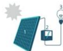
1. Zonnepaneel | 2. Omvormer 3. Elektrische toestellen
