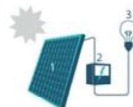
1. Zonnepaneel | 2. Omvormer 3. Elektrische toestellen
