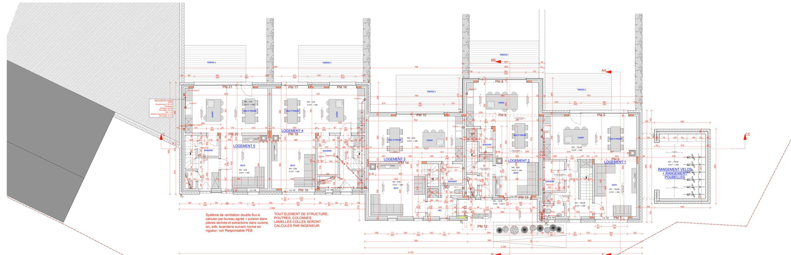
Systeme de ventilation double flux à calculer par bureau agréé + pulsion dans pièces sèches et extractions dans cuisine, wc, sdb, buanderie suivant norme en vigueur; voir Responsable PEB
