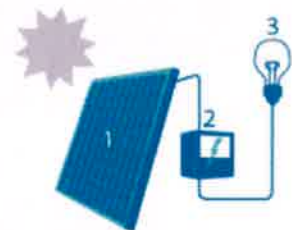
1 Zonnepaneel | 2 Omvormer | 3 Elektrische toestellen
