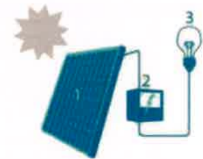
1. Zonnepaneel | 2. Omvormer | 3. Elektrische toestellen
